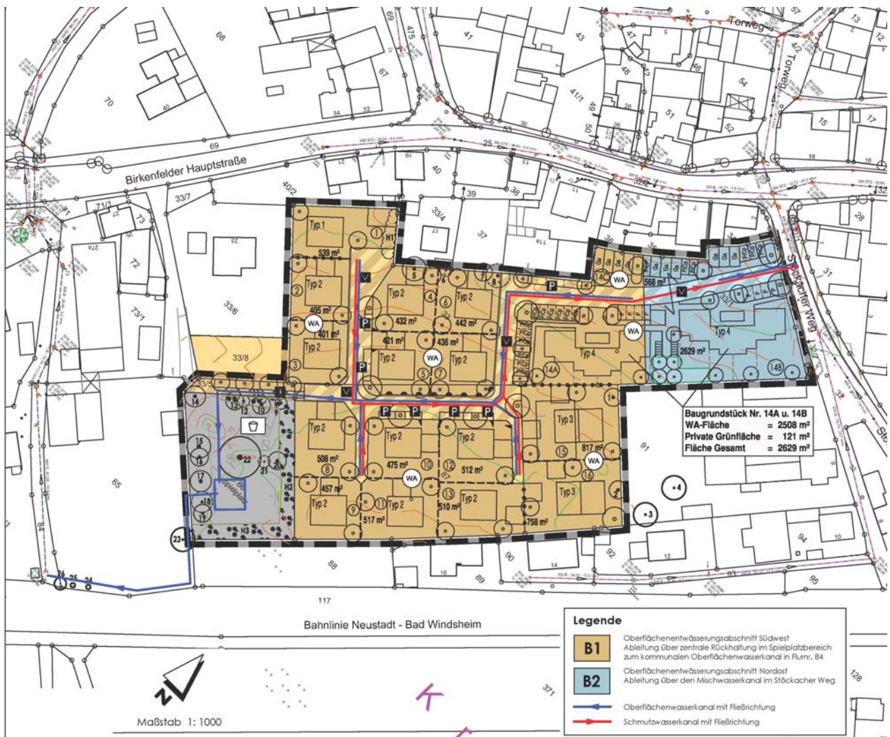
Oberflächenwasserableitung des Baugebietes in 2 Einzugsbereichen
